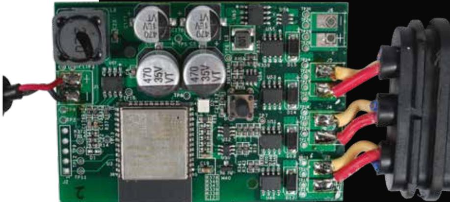
Рисунок 2. Печатная плата блока управления Twinkly
